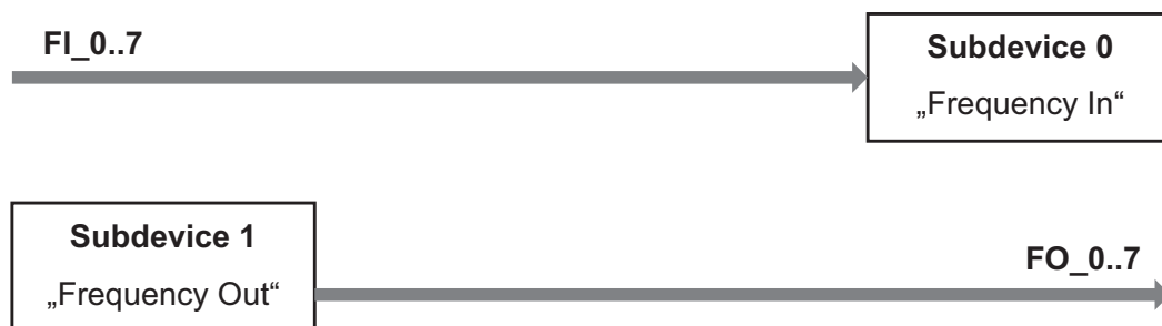
Abb. 7: Frequenz-Ein-/Ausgabe im „Single“-Betrieb
